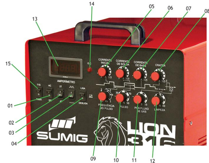
01) Chave Seletora AC/DC: quando na posição “AC”, soldaremos alumínio/magnésio e suas ligas. Quando na posição “DC”, soldaremos aço inoxidável, ferro, cobre e outros metais.
